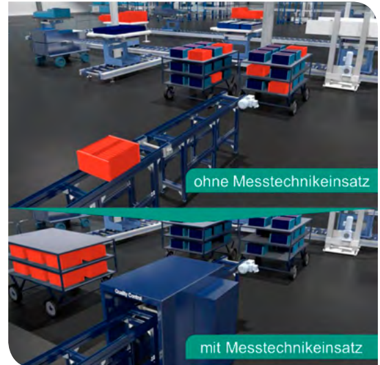
Mehrwert des prozessintegrierten Messtechnikeinsatzes nach dem Kontaktieren von Batteriezellen. (Bildquelle: ATZextra)
