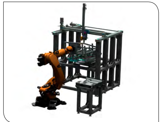
Insert-Integration in Preforms durch Pneumatikkolben
