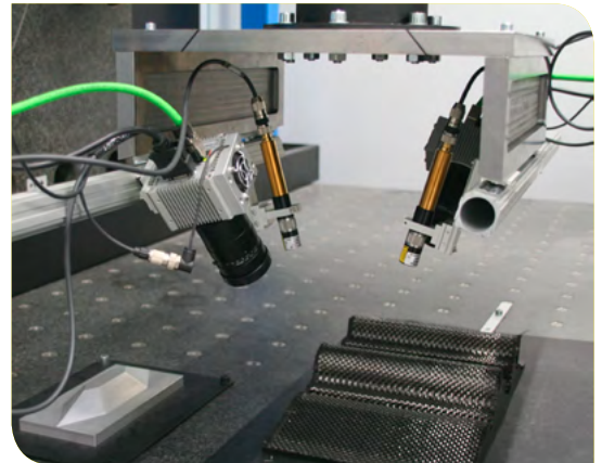
Leichtbauzelle für den Resin-Transfer-Moulding-Prozess
