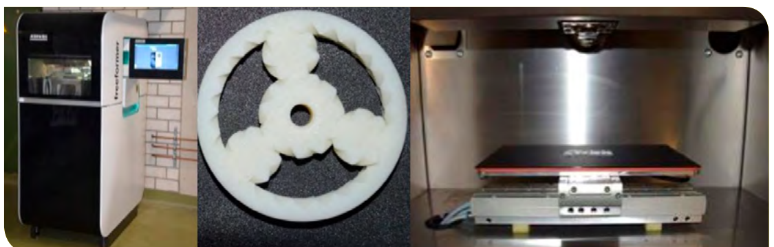
ARBURG Freeformer zur generativen Fertigung von Bauteilen
