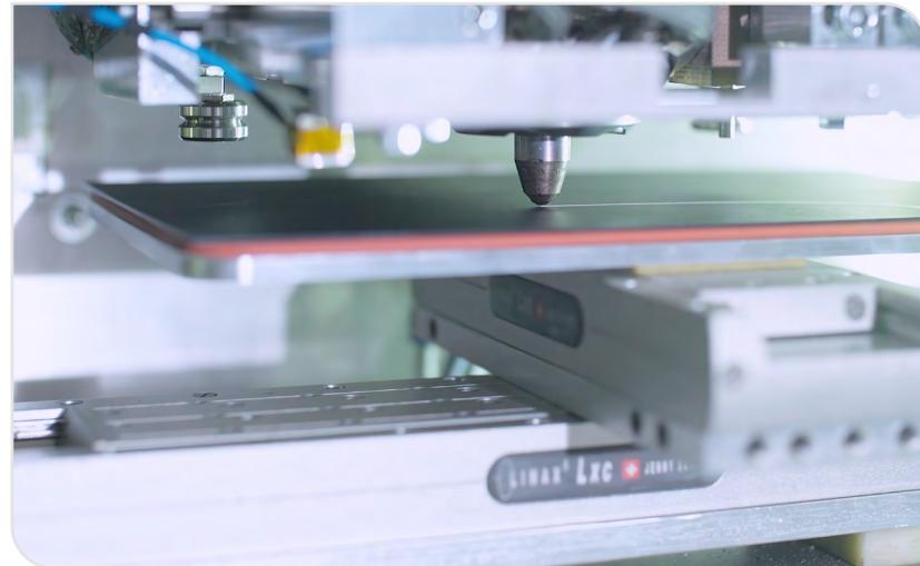
Erweiterung des Arburg Kunststoff Freiformen mit der Möglichkeit zur Integration von Endlosfasern (Foto: Robert Fuge)
