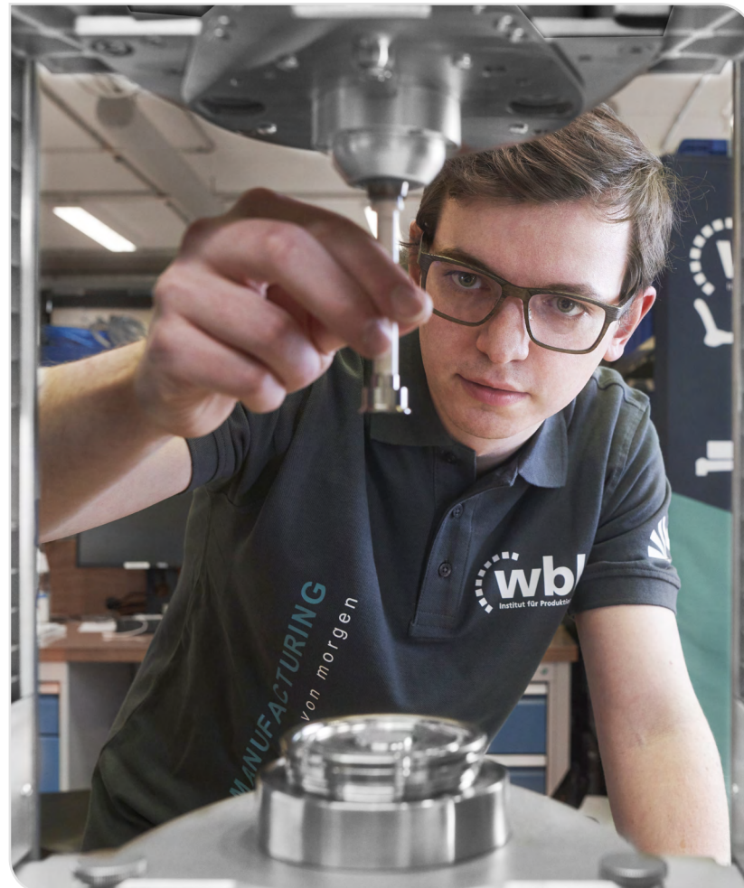
Rheometer zur Viskositätsuntersuchung von LCM-Schlickern (Foto: Amadeus Bramsiepe, KIT)
