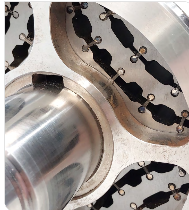
Prototyp einer hochdrehzahlfesten Reluktanzmaschine mit CFK-Verstärkungselementen (Foto: wbk/IEW)
