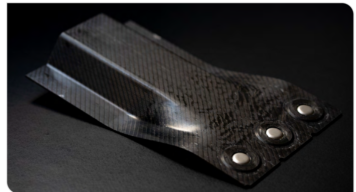
Exemplarische Anwendung punktschweißbarer Inserts: Anbindung eines CFK Dachquerträgers an die Fahrzeugkarosserie (Foto: wbk)
