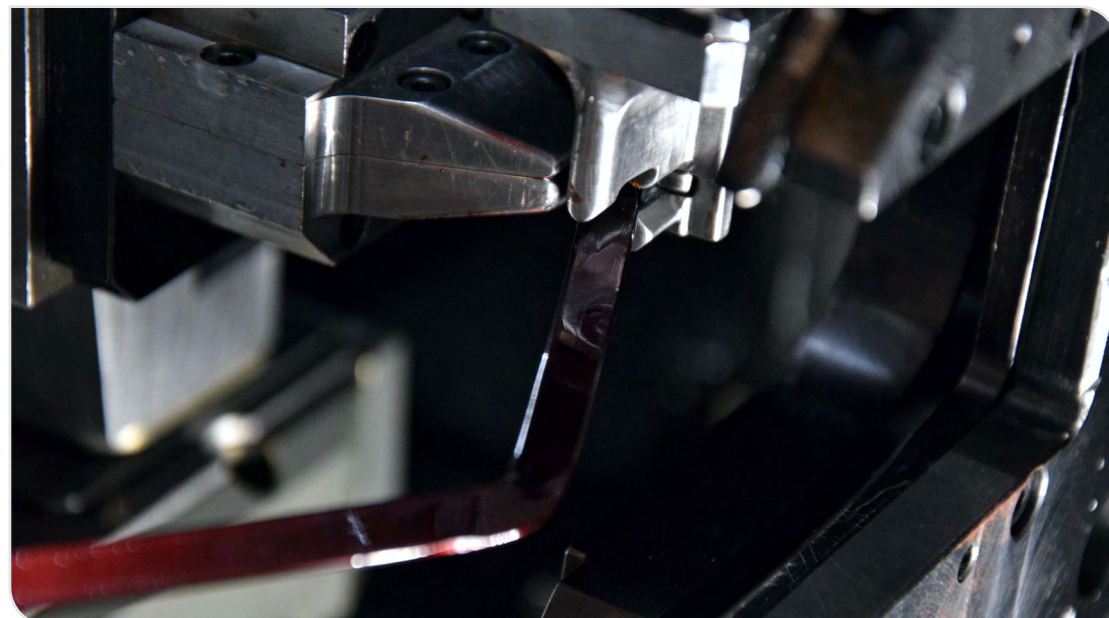
Fertigung von Hairpin-Steckspulen für elektrische Traktionsmotoren mittel kinematischer Formgebung (Foto: KIT/wbk)
