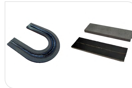
LS-Bauteile mit Endlosfaser (Foto: wbk)
