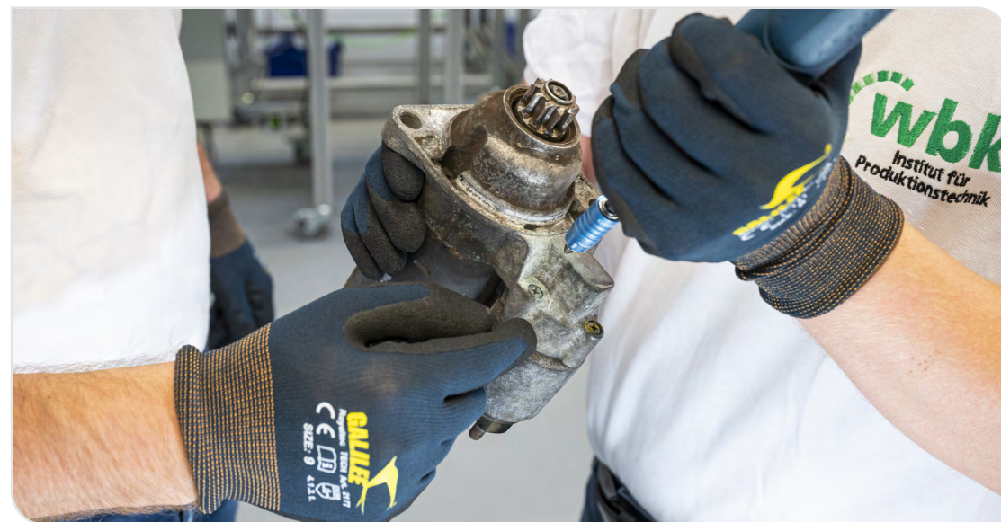
Manuelle Befundung und Demontage von gebrauchten Elektromotoren als Vorbereitung eines automatisierten Remanufacturings (Foto: wbk)
