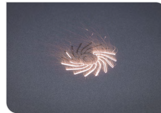
Laser-Pulverbettsschmelzen eines Impellers
