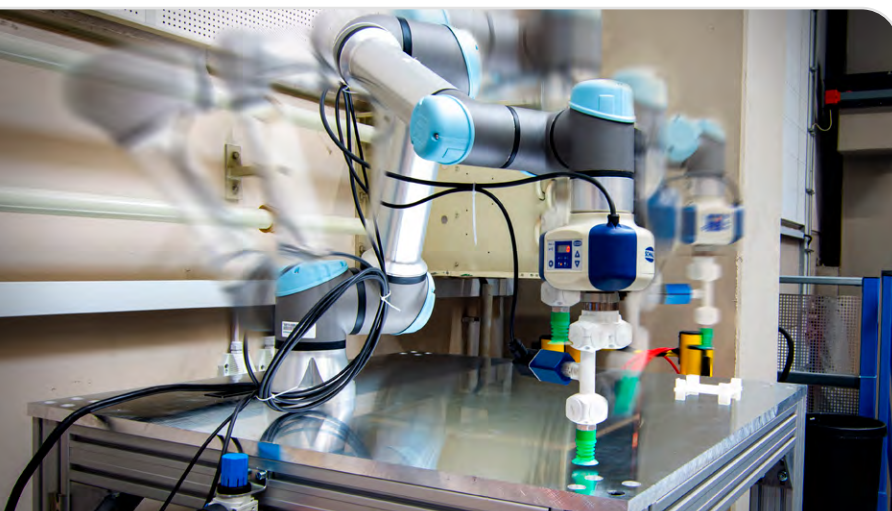
Intelligentes Greifsystem zur Materialerkennung von Textilien durch KI-gestützte Sensorintegration
