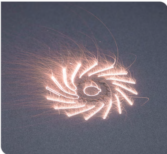
Additive Fertigung von Metall mit dem LPBF-Prozess (links) und von Keramiken mit dem LCM-Prozess (rechts)
