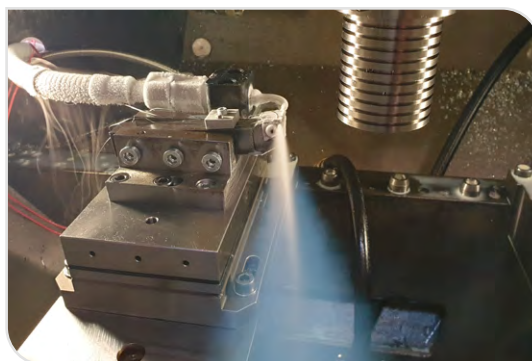
Kryogene Kühlung mit Stickstoff bei Drehen von Titan
