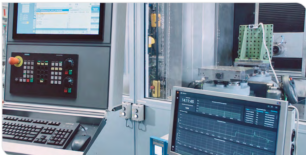
Werkzeugmaschine am wbk mit nachgerüsteten Industrie-4.0-Anwendungen
