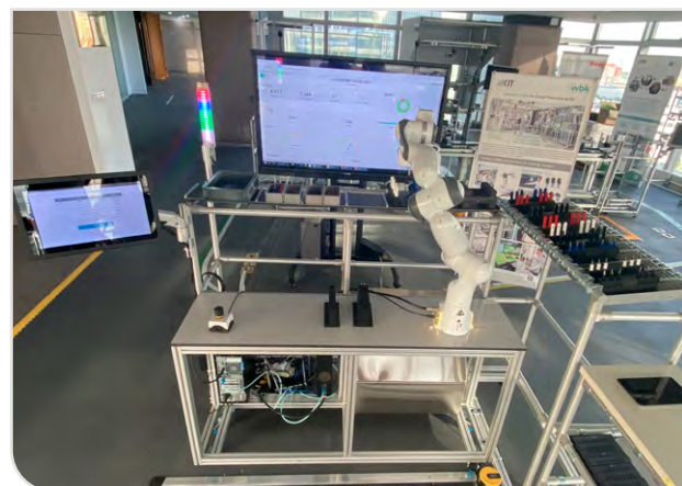
Demonstrator zum Thema skalierbare Mensch-Roboter-Kooperation
