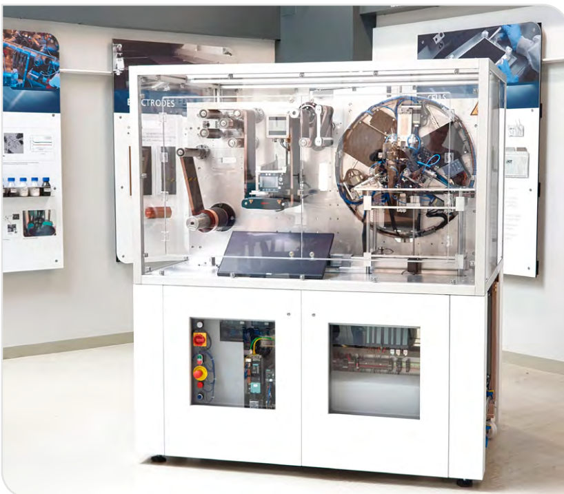
Coil2Stack – neuartiges Zellstapelbildungsverfahren zur formatflexiblen Produktion von Li-Ionen Batteriezellen
