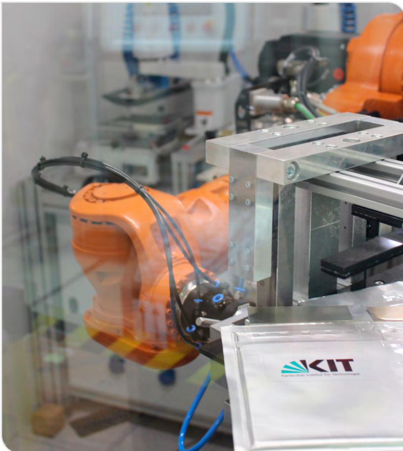
Formatflexible Batteriezellfertigung im Forschungsvorhaben SmartBatteryMaker
