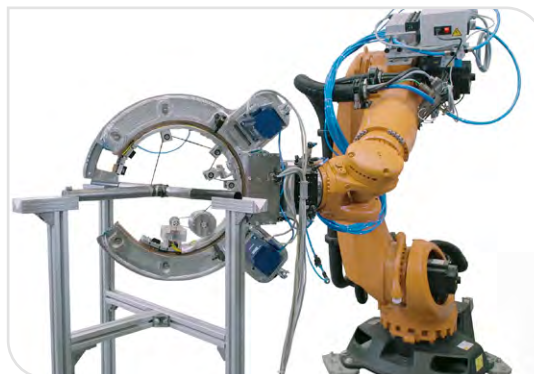
Aufbau des Fügewickelprozesses
